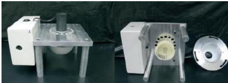
A la izquierda se presenta el equipo armado y a la derecha el equipo desarmado (Corzo *et. al.*, 2013)
