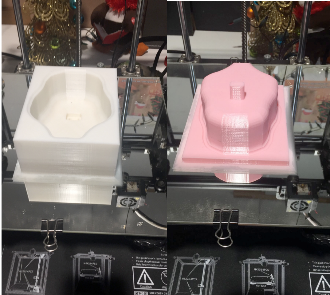
Impresión de los moldes 1, a la izquierda la tapa, a la derecha la base. (fuente propia 9)
