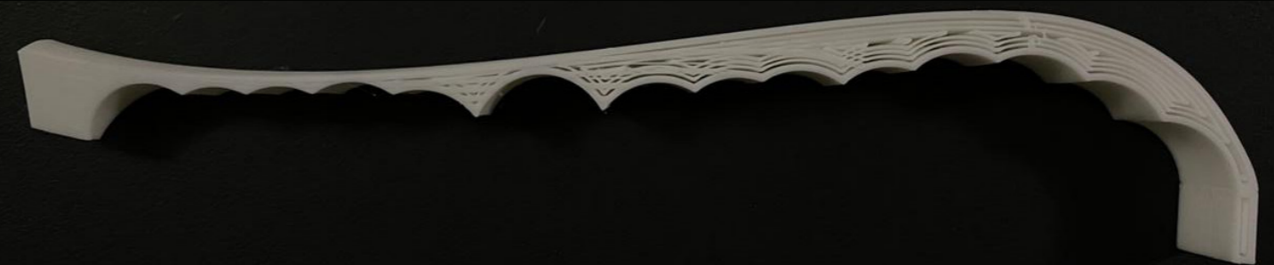
Fig 16: Prueba de relleno concéntrica.
