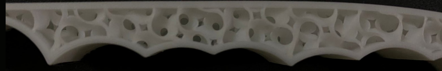
Fig 15: Detalle de prueba de relleno de giroide.
