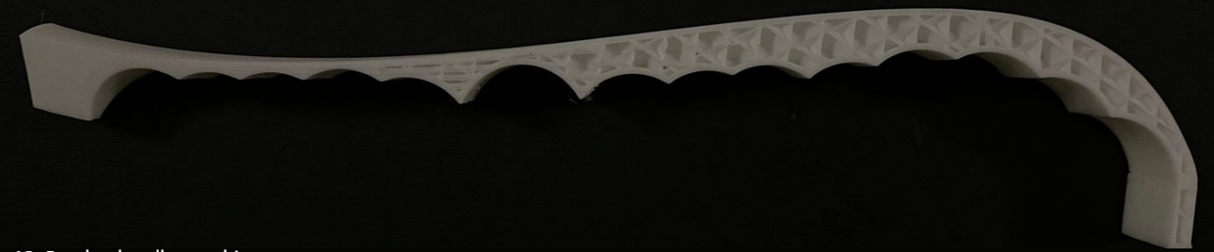
Fig 12: Prueba de relleno cubica.
