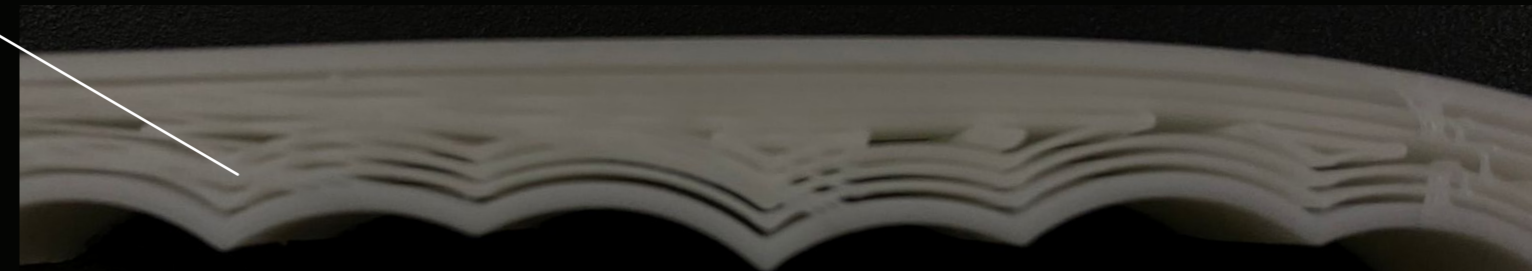
Fig 17: Detalle de prueba de relleno de concéntrica.
