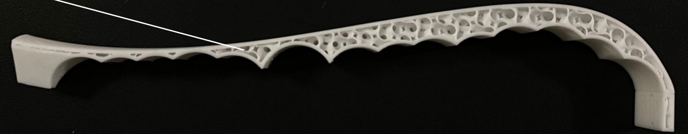
Fig 14: Prueba de relleno de giroide.
