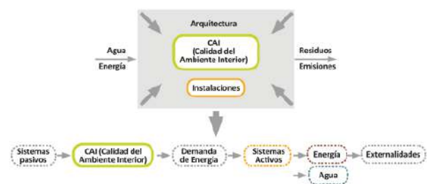
Figura 63. Modelo de relación entre las distintas categorías o ámbitos que influyen en el comportamiento ambiental del edificio.
