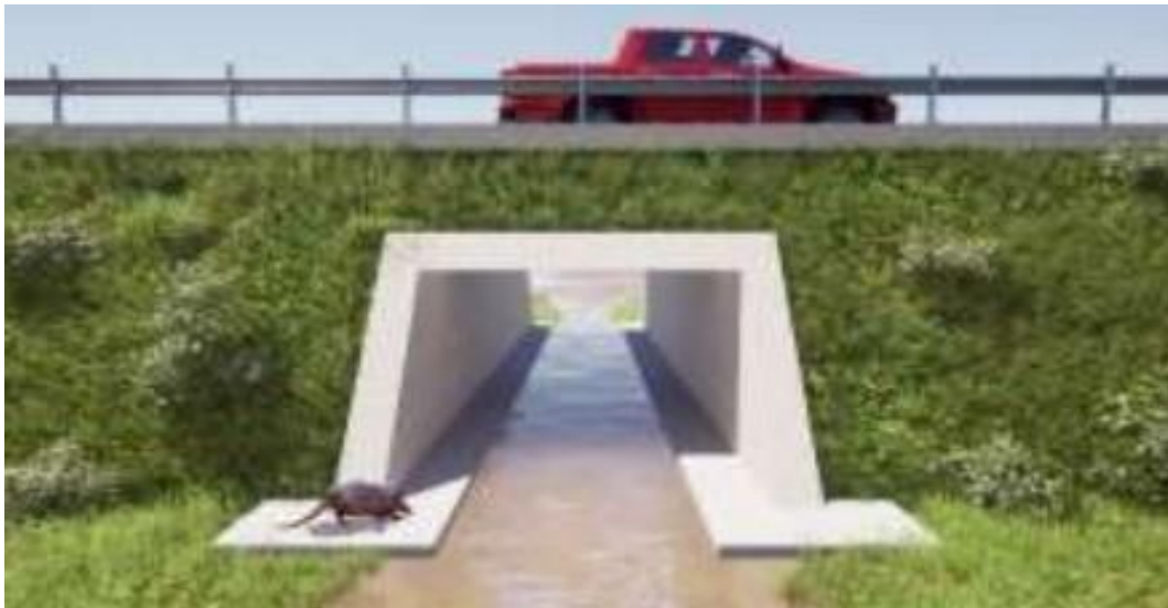
Figura 17. Prototipo de corredor biológico, estructura tipo Box con pasarelas bajas
