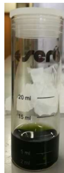
Figura 4.3: Resultado de la dureza total en la escala colorimétrica.
