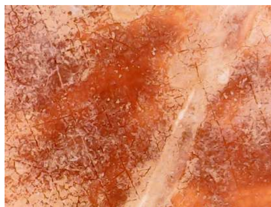
(b) Imagen superficial del de la membrana sucia, expuesta a la fase salina concentrada.
