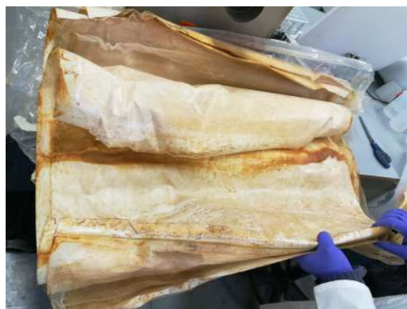
(b) Inspección visual superficial de la membrana.
