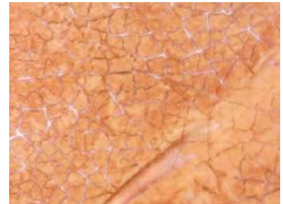
(c) Imagen superficial de la membrana interna de membrana sucia sonicada con ácido acético, que no está directamente expuesta a la fase de concentrado salino.
