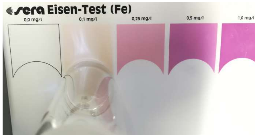
Figura 4.9: Resultado de la concentración de Fe en la escala colorimétrica.
