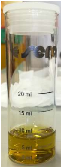
Figura 4.4: Resultado de la dureza de carbonatos en la escala colorimétrica.
