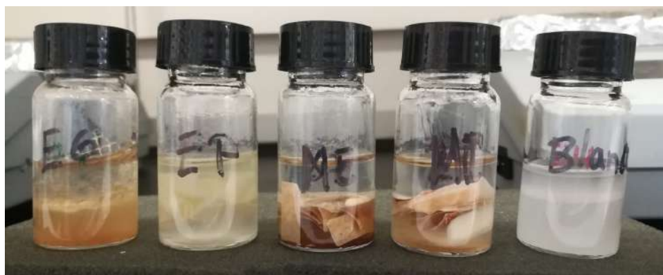
Figura 4.32: Imagen de los resultados obtenidos en la prueba Fujiwara de la muestra sucia, donde, de derecha a izquierda se analizó el espaciador de membrana externa, el espaciador interno, la muestra externa, la membrana interna y el blanco comparativo, correspondiente a la mezcla de NaOH - 10 [mol/L] con piridina.
