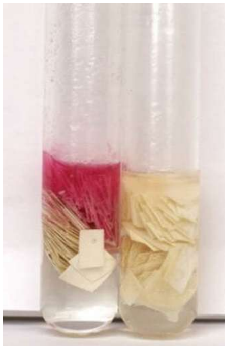
Figura 2.2: Ejemplo aplicado de la prueba de Fujiwara en membranas de lámina plana, obteniendo pruebas positivas (izquierda) y negativas (derecha). Imagen obtenida de [37].
