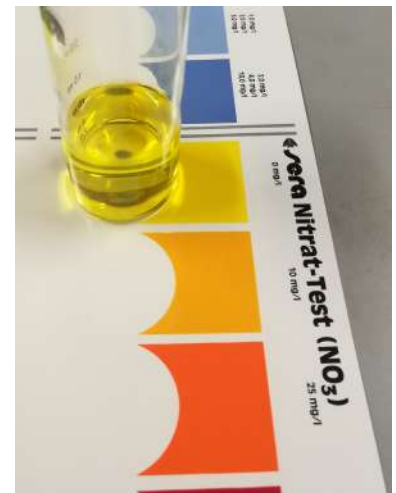
Figura 4.7: Resultado de la concentración de NO_3 en la escala colorimétrica.
