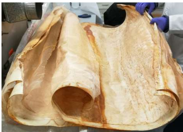
(a) Inspección visual de las capas de la membrana.
