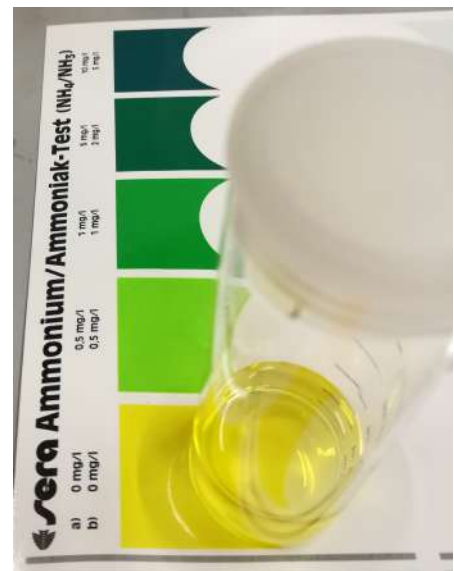
Figura 4.5: Resultado de la concentración de NH_3/NH_4^+ en la escala colorimétrica.
