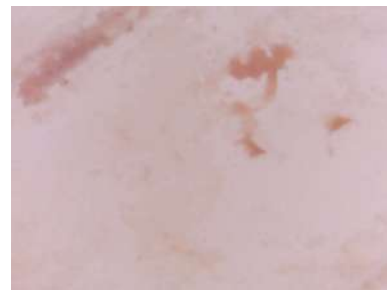
(c) Imagen superficial de la membrana interna de membrana sucia sonicada con HCl , que no está directamente expuesta a la fase de concentrado salino.
