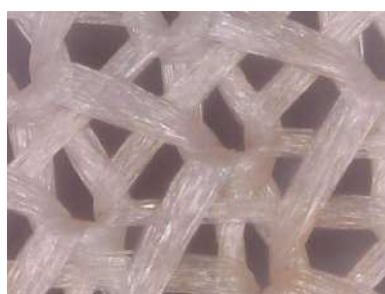
(b) Imagen superficial del espaciador interno de una muestra de membrana sucia sonicada con EDTA.
