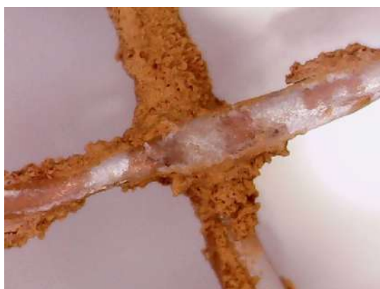
(a) Imagen superficial de las escamas de ensuciamiento del espaciador externo.
