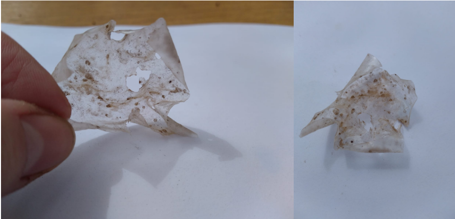
Figura 48: Muestra de biodegradabilidad de probetas generadas, en proceso experimental. Fuente: Elaboración propia.
