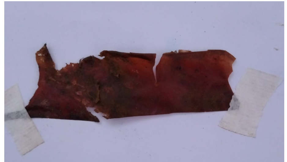
Figura 51: Prueba en tierra segunda fase de probetas canelo y agar agar, en proceso experimental. Fuente: Elaboración propia.
