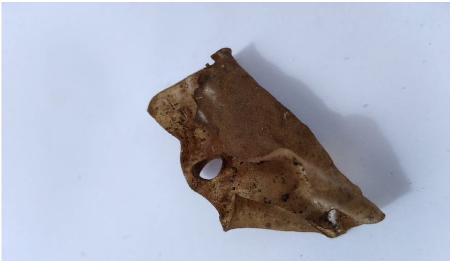
Figura 49: Muestra de biodegradabilidad de probetas generadas, en proceso experimental. Fuente: Elaboración propia.
