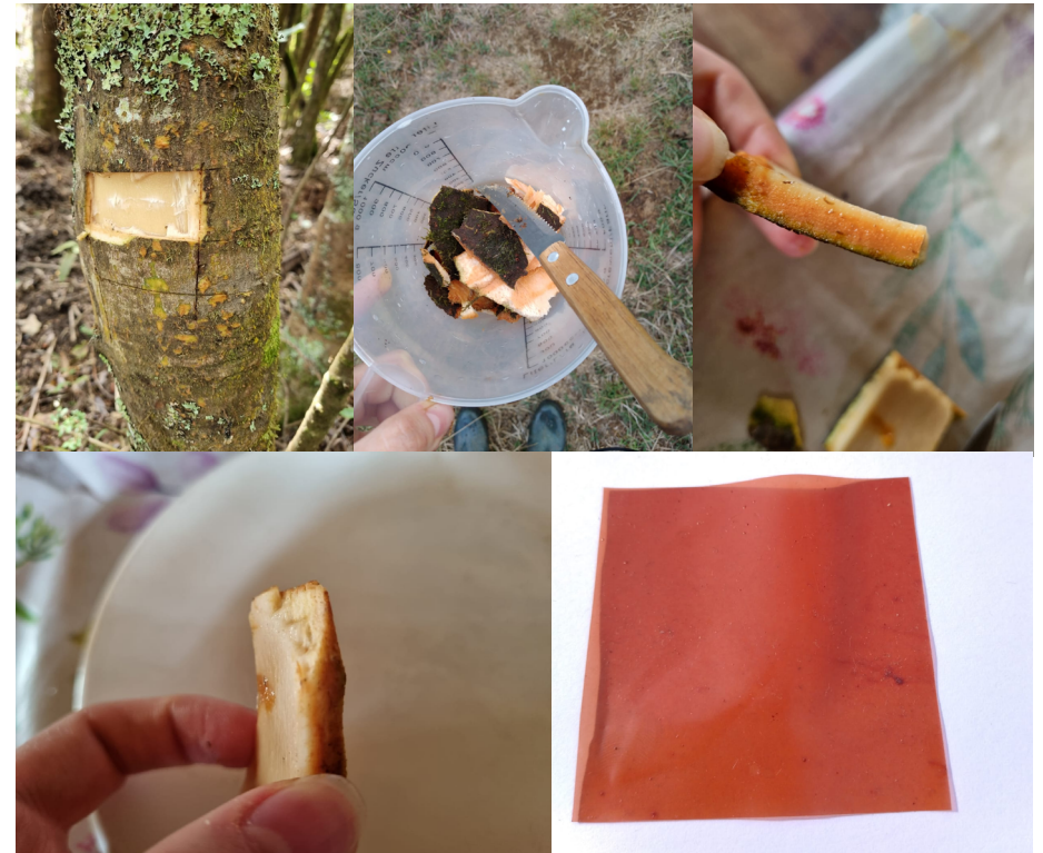
Figura 38: Imágenes de extracción de corteza de árbol canelo y probeta de bioplástico agar agar y canelo resultante. Fuente: Elaboración propia.
