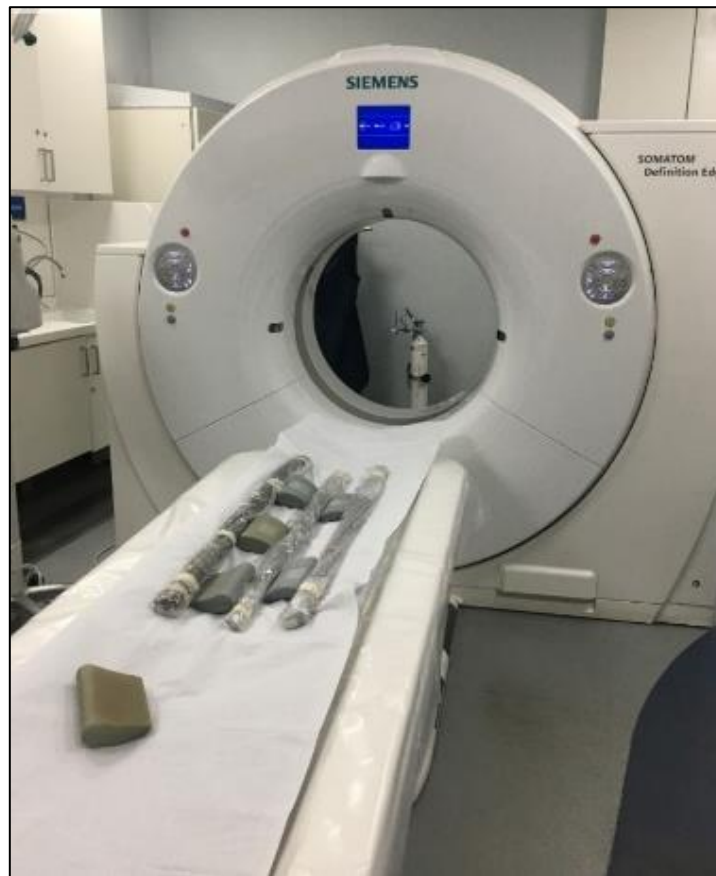
Figura 3.4. Imagen de maquina utilizada en la tomografía de los testigos, SOMATOM Definition Edge de Siemens, extraído y modificado de Vásquez A, (2022).
