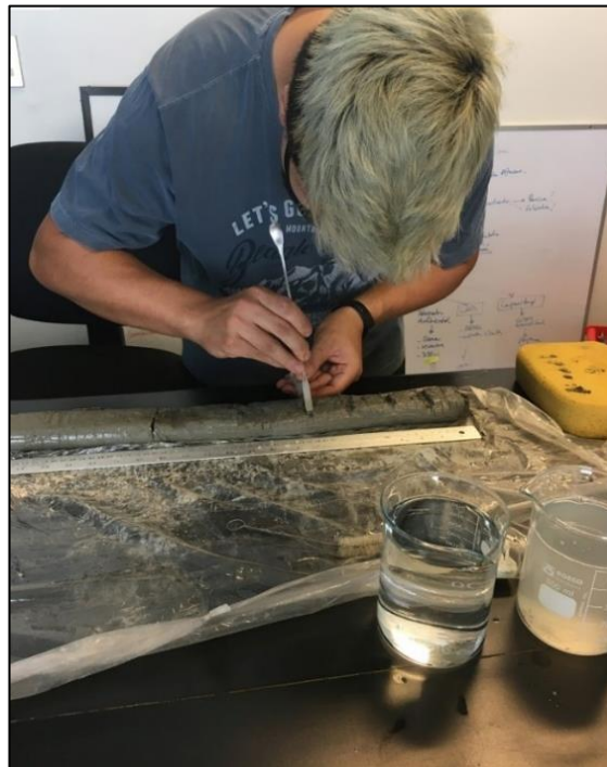
Figura 3.6 Extracción de muestras para granulometría y FRX, imagen extraída y modificada de (Vásquez, 2022).
