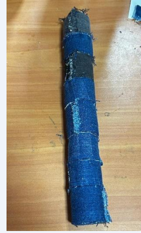
Imagen 53: Torre de rollos unidas mediante costura.
