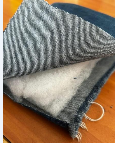
Imagen 59: Se introduce la napa en la funda.
