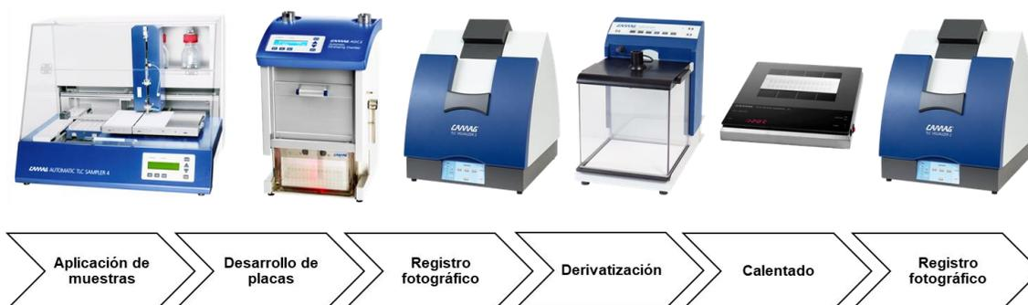
**Figura 5. Esquema del proceso automatizado de análisis por CCF de alta resolución con instrumentación CAMAG®.** La aplicación de las muestras previamente resuspendidas se realizó con el equipo *Automatic TLC sampler 4* en placas de CCF de alta resolución en soporte de vidrio. Las placas fueron luego desarrolladas en el equipo *Automatic Developer Chamber ADC2* y fotografiadas en el equipo *TLC Visualizer*. La derivatización de las placas se llevó a cabo en el equipo *Derivatizer*.
