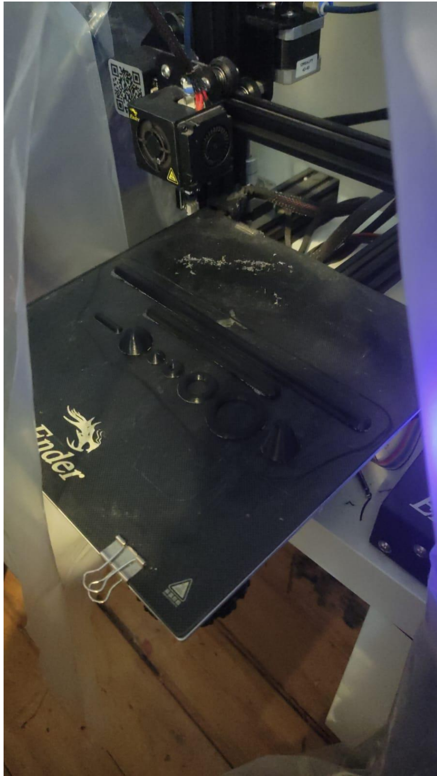
Ilustración 13 Proceso de impresión 3D con filamento ABS
