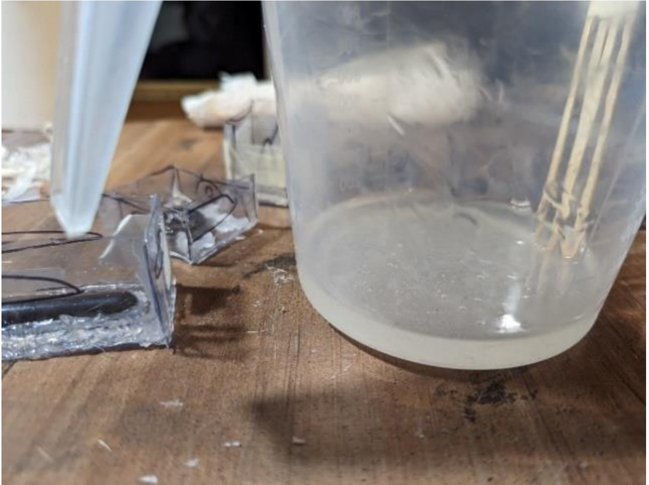
Ilustración 35 Mezcla de silicona con trozos de silicona fraguada
