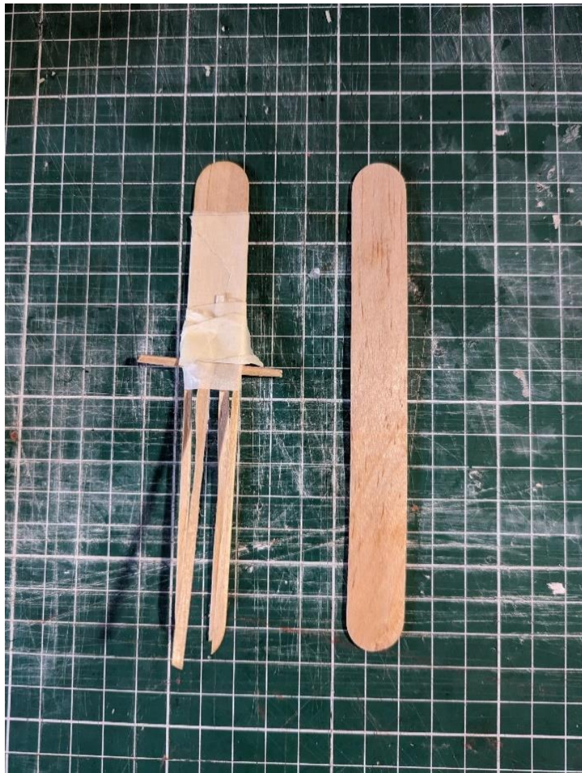
Ilustración 40 Instrumento de madera creado para batir la silicona
