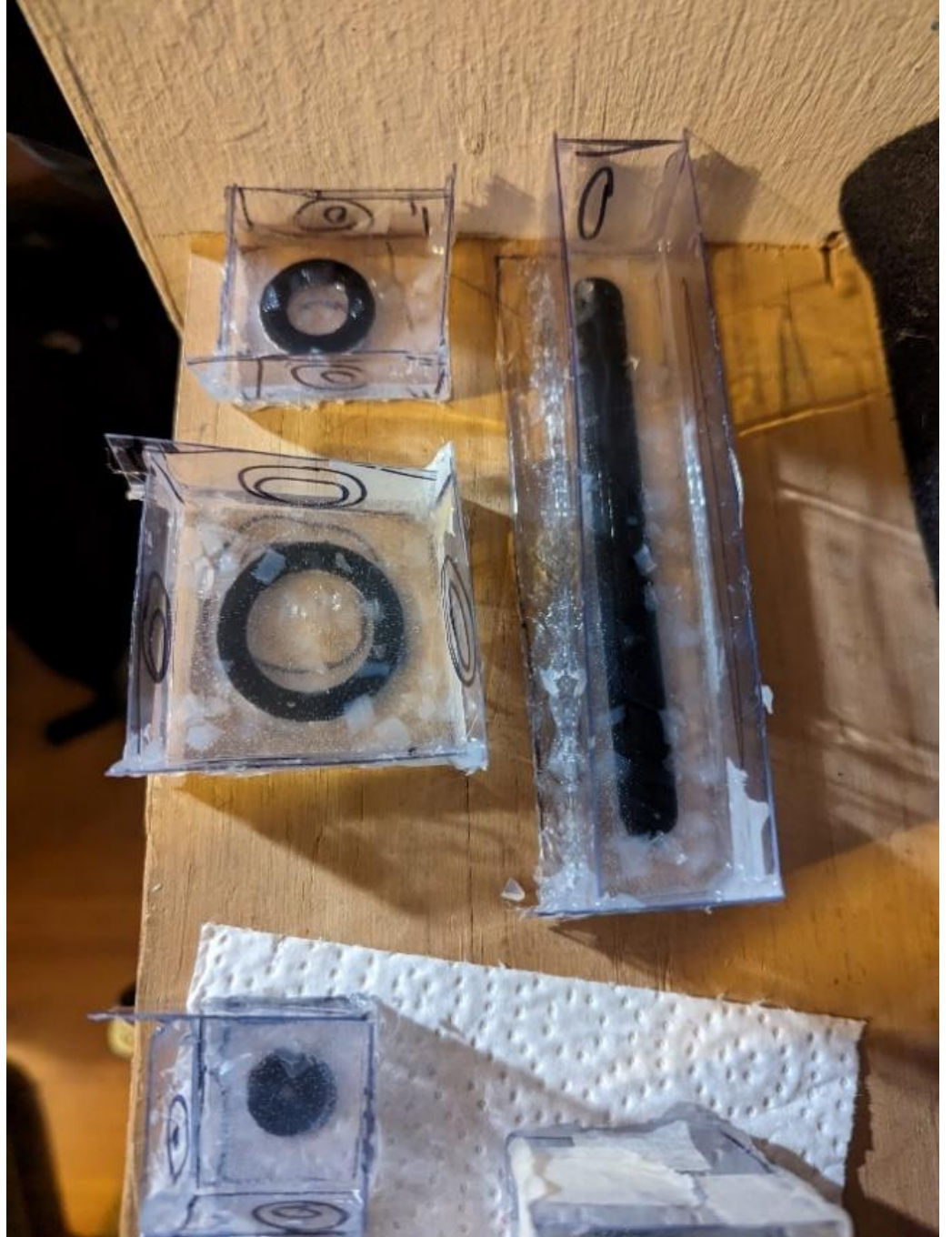
Ilustración 36 Moldes en reposo mientras fraguan
