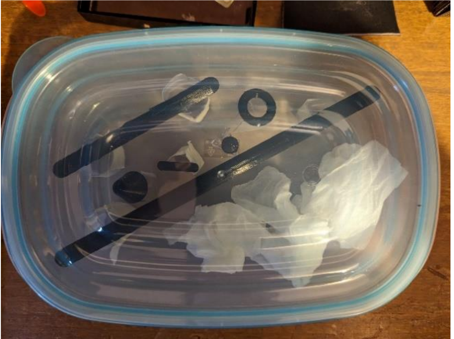
Ilustración 19 Primera prueba de pulido con vapor de acetona
