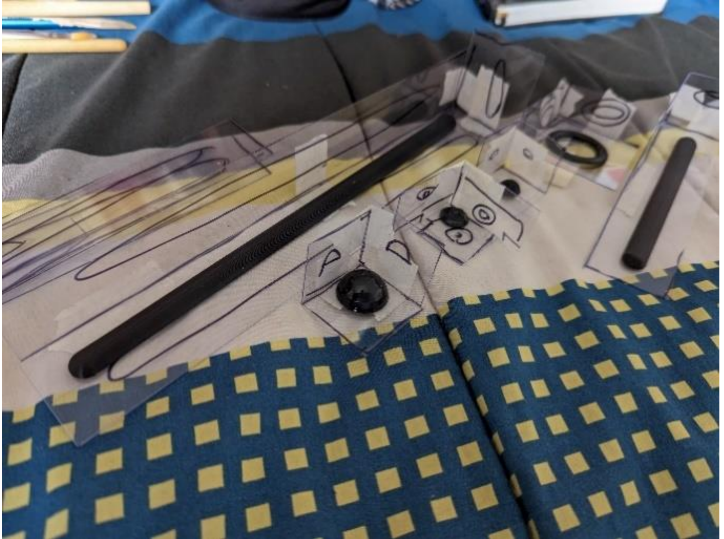
Ilustración 17 Montaje de los envases para la realización de los moldes
