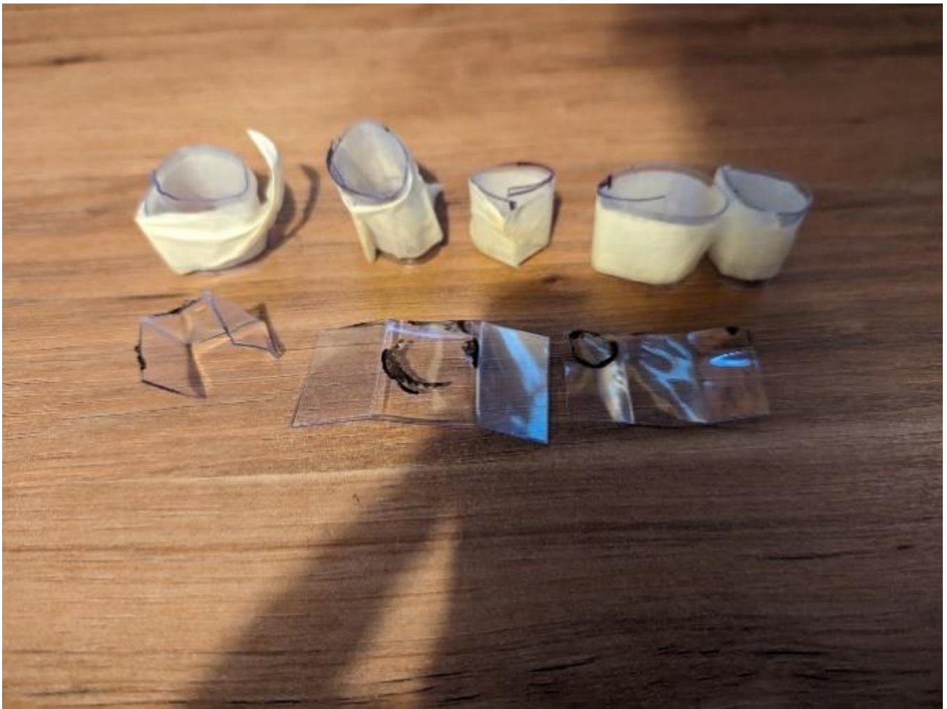
Ilustración 23 Efectos del vapor de acetona sobre los soportes de mica
