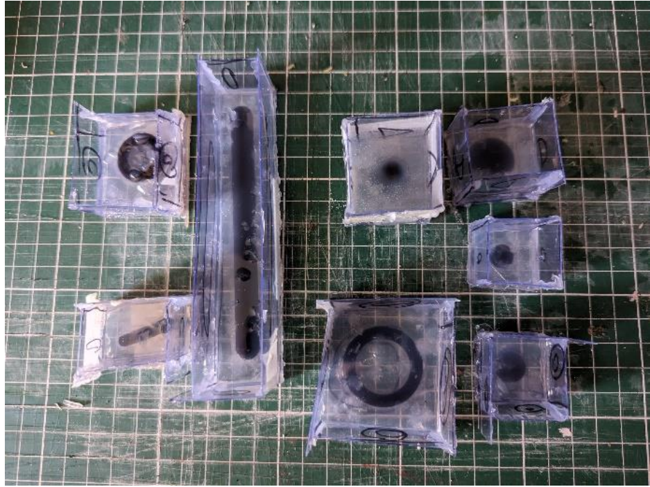
Ilustración 38 Moldes fraguados sin desarmar
