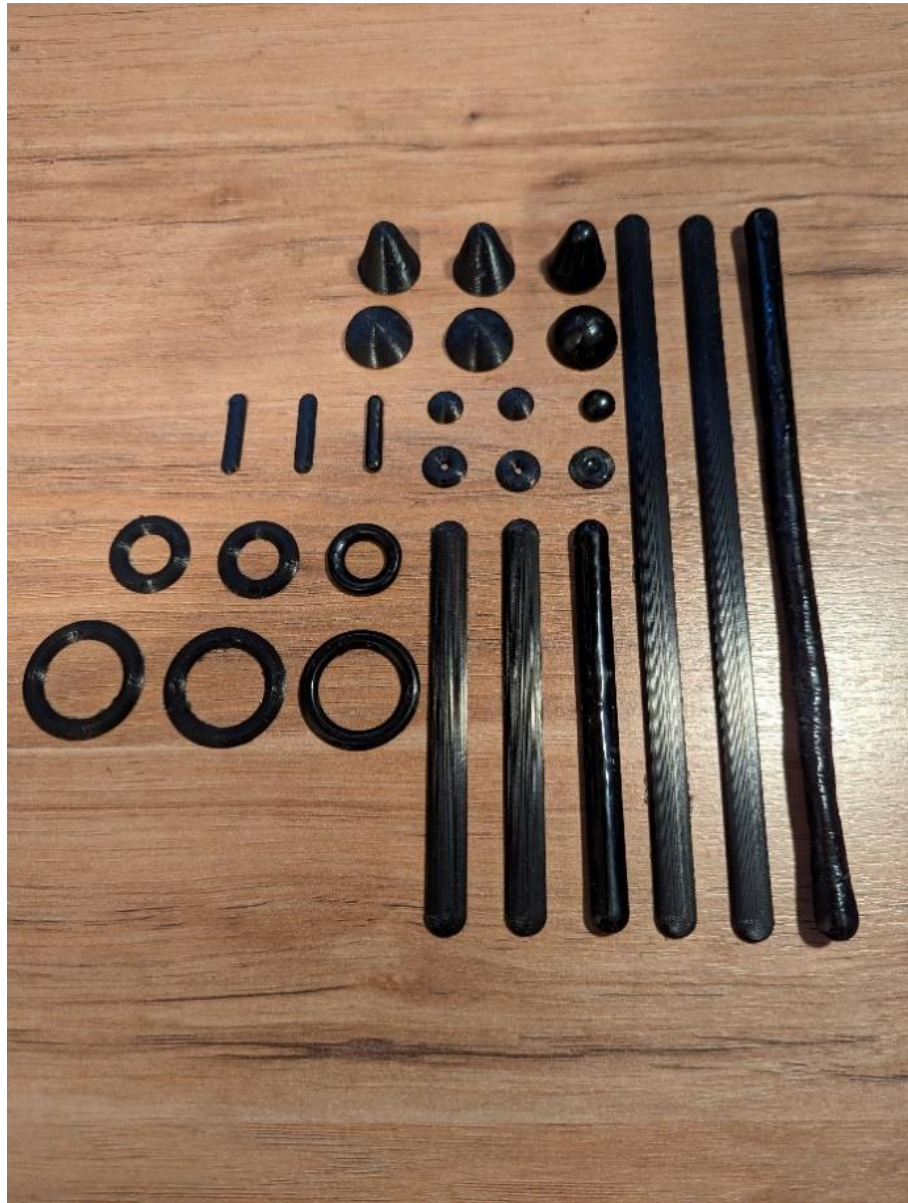
Ilustración 22 Comparación piezas sin pulir, pulido con piroxilina y pulido con acetona
