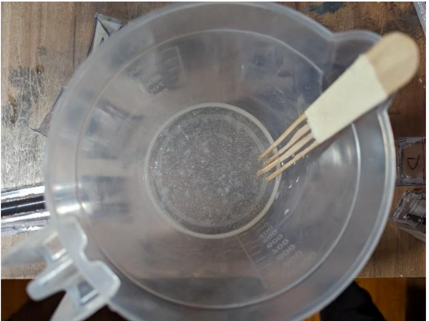
Ilustración 34 Mezcla de silicona con pedazos de silicona reaprovechado
