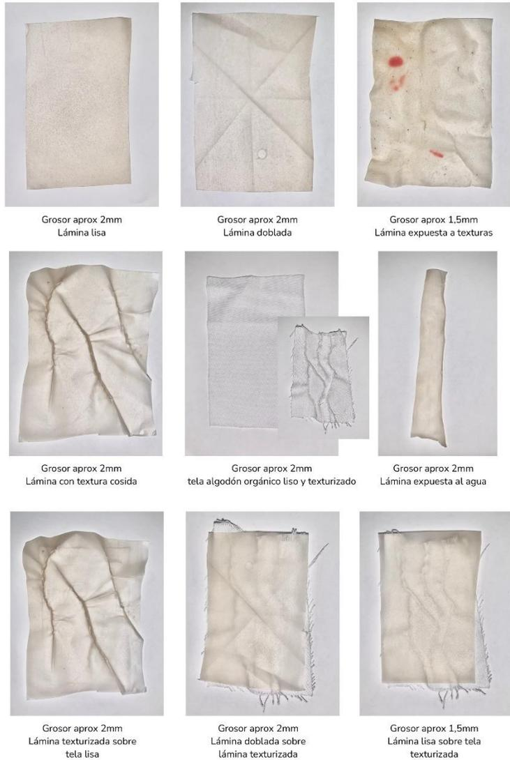
Figura 57. Experimentación con el biomaterial. Esquema comparativo. Elaboración propia.
