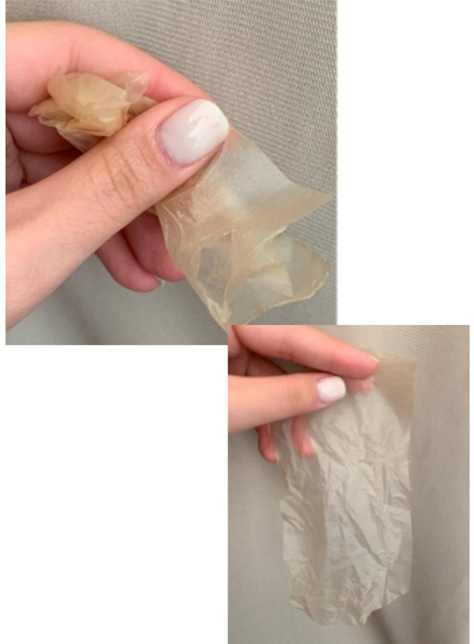
*Figura 25. Material prueba de resistencia a pliegues. Elaboración propia.*
