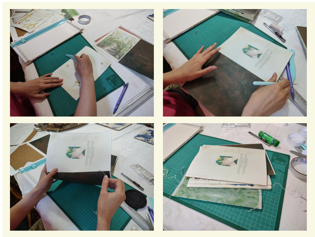
Fig. 61. "Uso de plegadera, punzón y aguja para la encuadernación de los cuadernillos". Fotografías personales.
