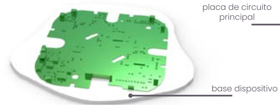
Imagen 37. Render base dispositivo y placa de circuito principal. Elaboración propia.
