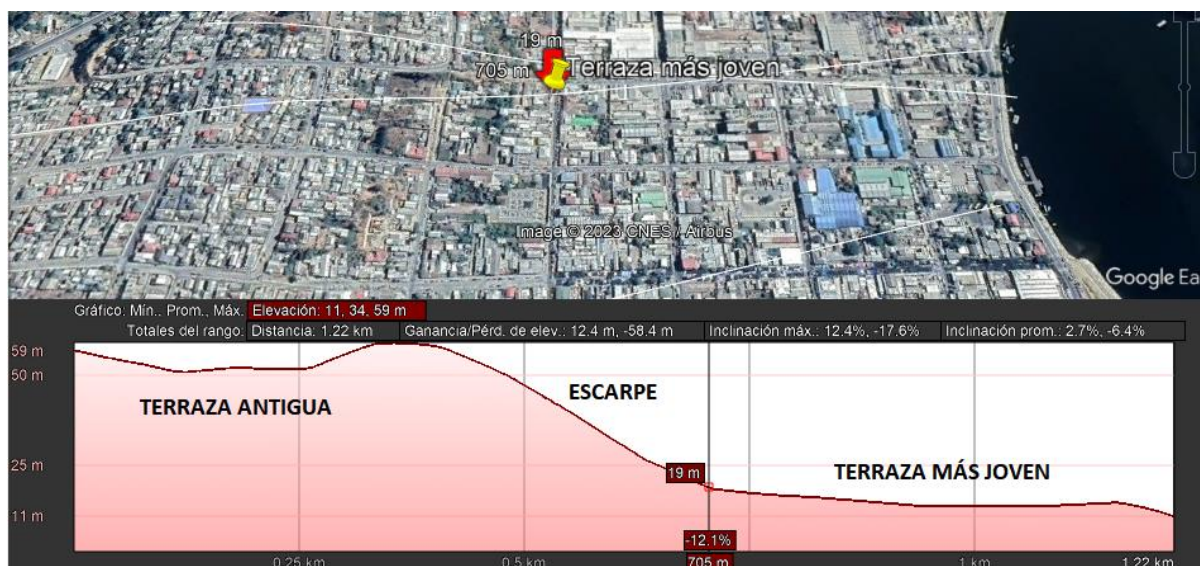
Figura 16. Perfil de elevación para delimitación de terraza fluvio-marina, comuna de Constitución.
