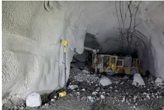
Figura 10: Equipo siniestrado en accidente fatal producto de bombeo de finos, Ridgeway Deeps (NSW Department of Industry, 2017)
