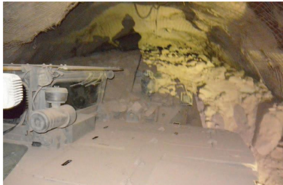
Figura 4: LHD R2900 enterrado por bombeo de fino (Long et al., 2017)
