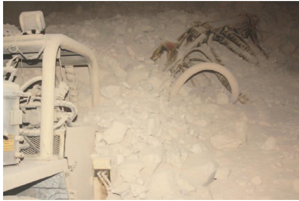
Figura 3: Spraymec enterrado por bombeo de fino (Long et al., 2017)
