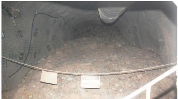
Figura 2: Vista frontal de bombeo de fino en Mt Wright (Long et al., 2017)
