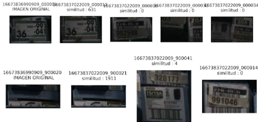
Figura 3.7: Resultados al utilizar el algoritmo LoFTR para encontrar similitud entre imágenes. Sobre las imágenes se muestra el detection_id asociado y la cantidad de matches encontrados con la detección original.
