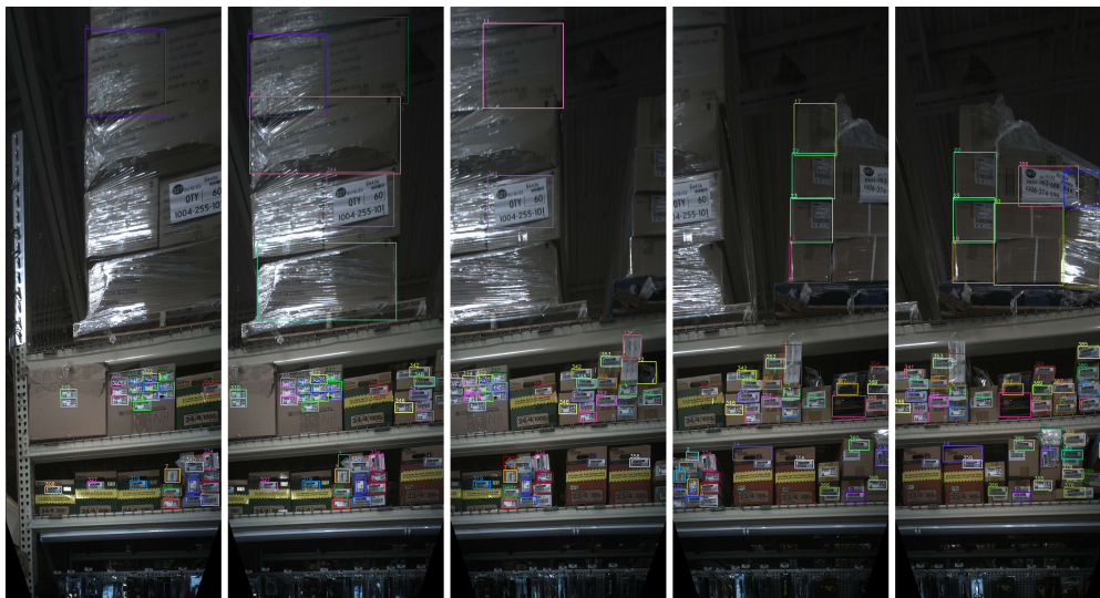
Figura 4.3: Visualización de un sector del pasillo que muestra el seguimiento simultáneo de varios objetos. Los objetos consolidados se identifican mediante el uso de números y colores correspondientes. Los objetos con el mismo número y color están consolidados, lo que indica que corresponden a una misma entidad a lo largo de las secuencias de imágenes capturadas.
