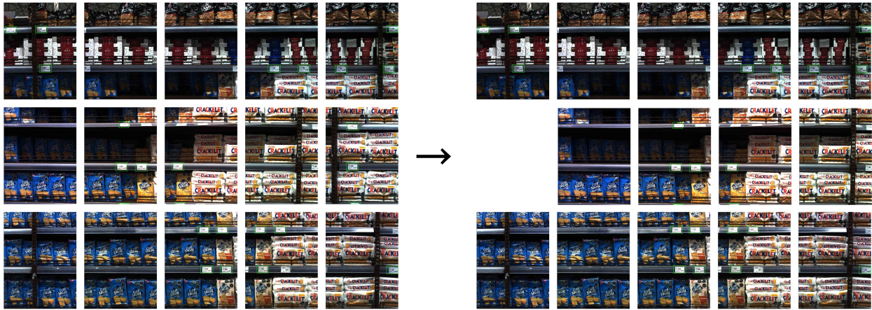
Figura 3.11: Problema de falta de captura en una cámara. La primera imagen muestra el orden incorrecto en el que se leen las imágenes, lo que resulta en una falta de congruencia temporal. La segunda imagen muestra el orden correcto para asegurar la congruencia de las imágenes capturadas por las tres cámaras.
