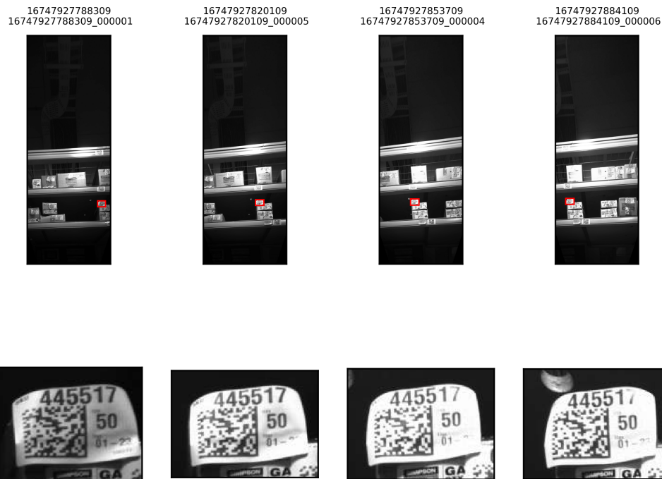
Figura 4.1: Visualización del seguimiento y consolidación de un objeto a través de una secuencia de imágenes. En el título de las imágenes se muestra el nombre de la captura y la detección correspondiente marcada. Las imágenes de la segunda fila muestran un acercamiento de la detección para permitir una mejor visualización de los detalles.
