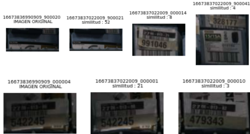
Figura 3.6: Resultados al utilizar el algoritmo SIFT para encontrar similitud entre imágenes. Sobre las imágenes se muestra el detection_id asociado y la cantidad de matches encontrados con la detección original. Las detecciones están ordenadas de la más parecida a la original a la menos similar. Se destaca que no es necesario que las detecciones tengan contenido legible para encontrar matches.
