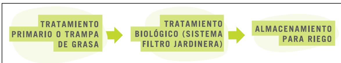
Figura 5-2: Etapas del sistema de tratamiento Filtro Jardinera (MINVU, 2018).
