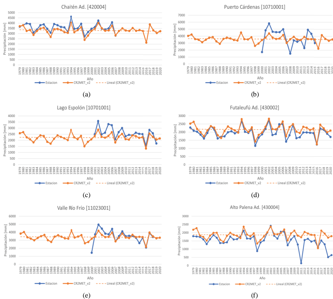
Fig. 10. Comparación de las series de precipitación anual medidos por la DGA (azul) y las modeladas por el CR2MET (rojo). Fuente: Elaboración propia con datos de precipitación de la DGA y del CR2Met.
