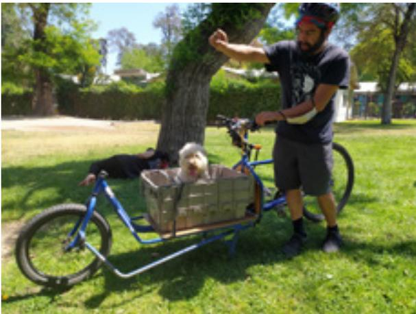
2. **YobkeCargoBike:** Fabricante radicado en la ciudad de Concepción dedicado a las bicicletas de carga. Fabrica el modelo tipo Long John y se caracteriza por reciclar la parte trasera de una bicicleta estándar a la cual le agrega nueva tubería con la cual forma la base de carga delantera. Manda bicicletas a clientes de todo el país.
