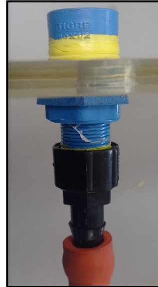
“Figura 25: Esquema de Prototipo RW asistido con presiones reducidas y adaptador de manguera respectivamente (invención propia)”
