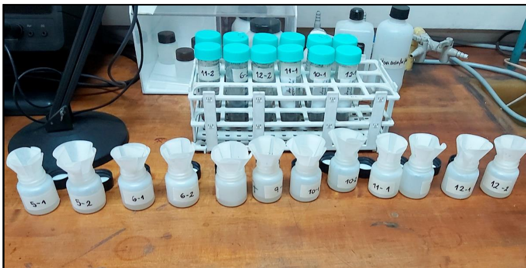
Figura 8. Determinación de micronutrientes mediante extracción con DTPA.
