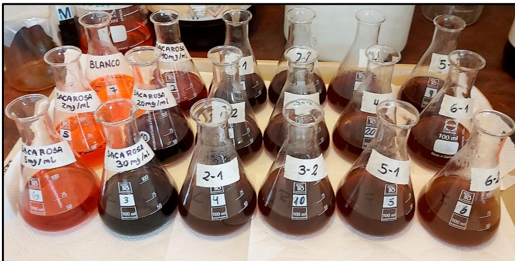
Figura 6. Determinación de Carbono Orgánico mediante el procedimiento de Sadzawka y Walkley y Black.
