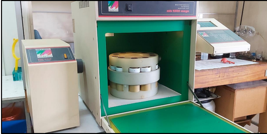
Figura 15. Determinación de contenido pseudototal de metales utilizando un equipo de microondas.
