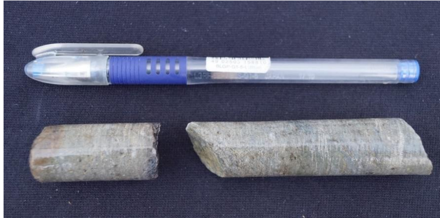
Figura 2.3: Toba cristalina perteneciente a Formación Tobífera con cloritización débil a media.
