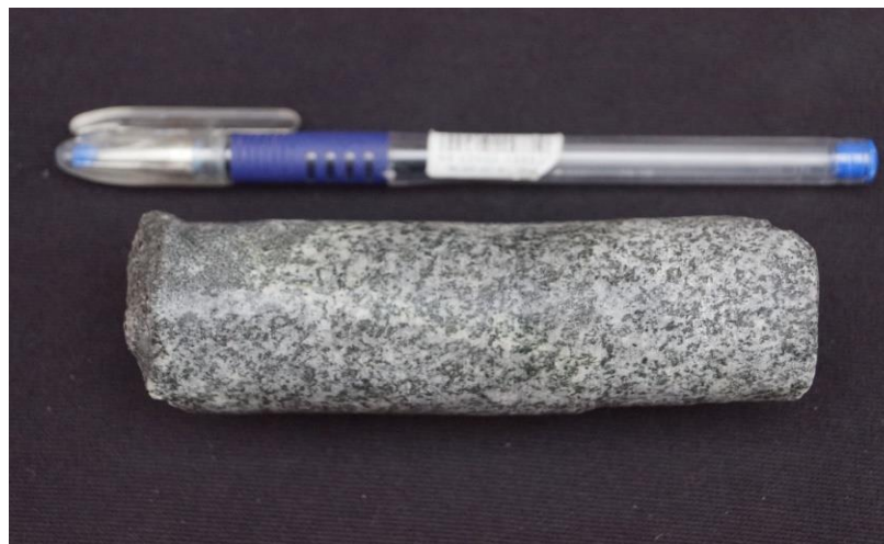
Figura 2.4: Dique diorítico sin alteración, con presencia de anfíbol y magnetita. Muestra recuperada en el sector de Mina Cutter.
