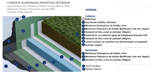
Detalle de Cubierta Verde
