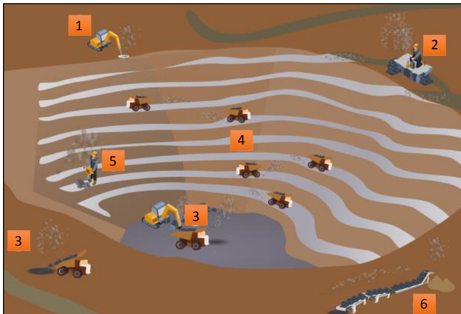
Ilustración 2: Esquema de actividades generadoras de material particulado en suspensión en operaciones rajo abierto (Ortiz, 2015).
