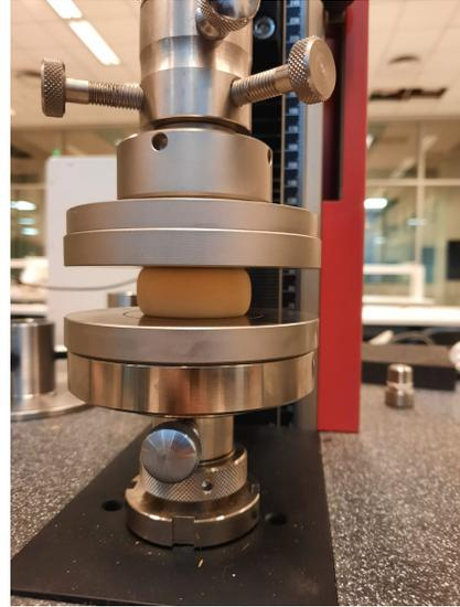
(b) Ensayo de compresión
