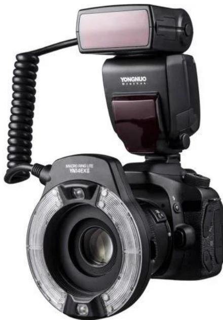
**Figura 4. Flash anular.** Se observa un flash anular montado a una cámara DSLR (Ebest, s/f)
