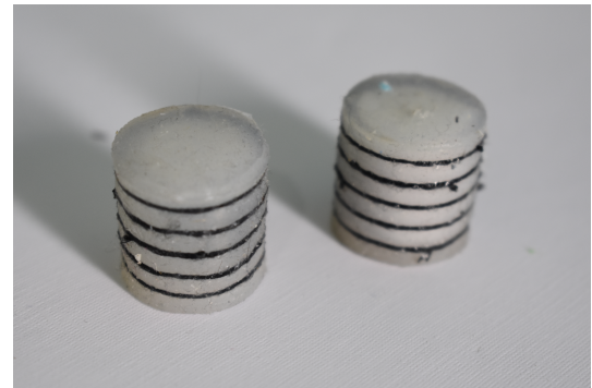
(b) Muestra de núcleo uniaxial devanado con hilo negro.
