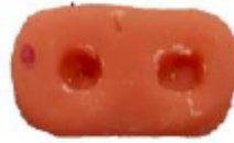
Figura 10: Base de acrílico para posicionar muestras en microdurómetro. Imagen obtenida de este estudio. Las muestras del modelo in situ fueron ubicadas en esta base con cera adhesiva para medir su microdureza.
