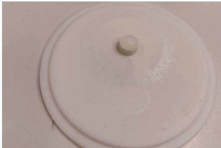
Figura 3.5: Disco de LLNO sinterizado
