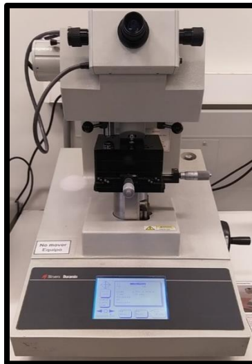
Figura 10. Microdurómetro Duramin de Struers®. Proporcionado por la facultad de ciencias físicas y matemáticas de la Universidad de Chile.
