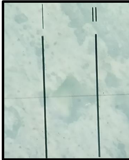
Figura 9. Microindentadura en bloque de esmalte. Realizado para la medición de dureza del esmalte de la muestra.
