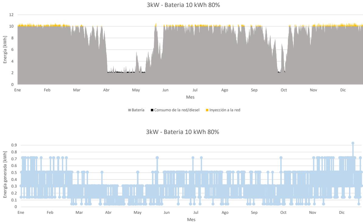
Figura 4.29: Sistema eólico Consumo base con sistema de baterías 10 kWh.
