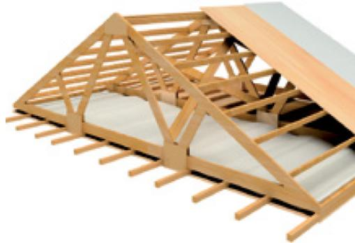
Figura 4.7: Estructura básica de un techo con cerchas [39].
