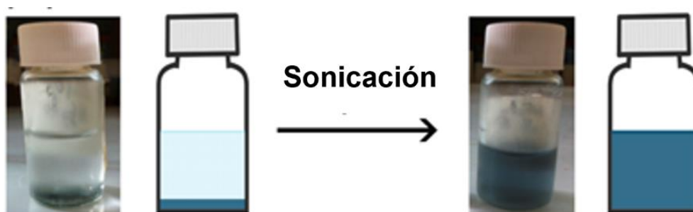
Figura 26. Esquema y fotografías que muestran el proceso de aglomeración y resuspensión de AuNS. A la izquierda las nanopartículas aglomeradas en el fondo del recipiente, a la derecha luego de ser resuspendidas por sonicación.
