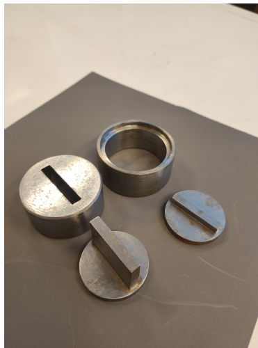
Figura 3.1: Matriz destinada a la geometría de barra
