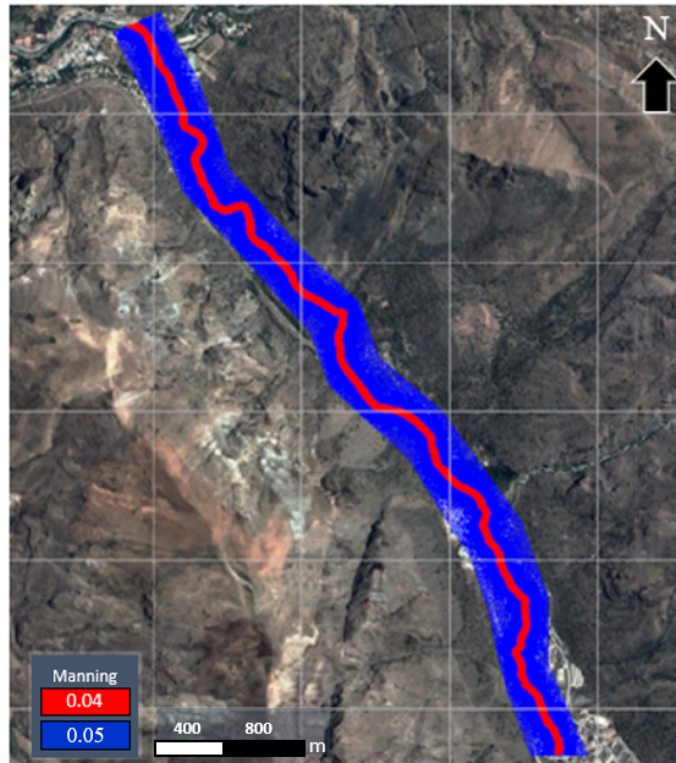
Figura 4.7: Coeficientes de Manning en BlueKenue definidos para el valle (azul, n=0,05 ) y el cauce (rojo, n=0,04 ). Fuente: Elaboración propia.
