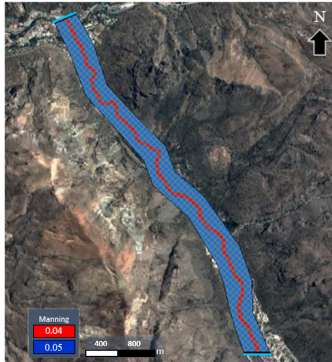
Figura 4.5: Coeficientes de Manning en HEC-RAS definidos para el valle (azul, n=0,05 ) y el cauce (rojo, n=0,04 ). Fuente: Elaboración propia.
