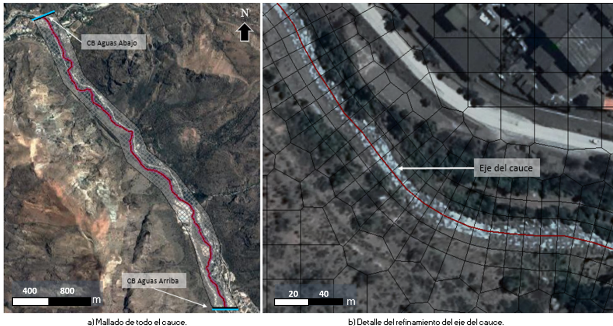
Figura 4.4: Malla elaborada en HEC-RAS. La Figura a) muestra el área de estudio, mientras que la Figura b) muestra el detalle del refinado del cauce. Fuente: Elaboración propia.
