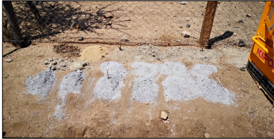
Figura 4.6: Detalle de las muestras litológicas obtenidas en la perforación del Pozo de Producción del SSR Quilitapia, Combarbalá. Fuente: Hydro-Drilling (2020)[41]
