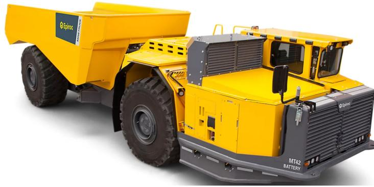
Figura 2.4: Camión de acarreo subterráneo de Epiroc modelo MT42 con baterías.
