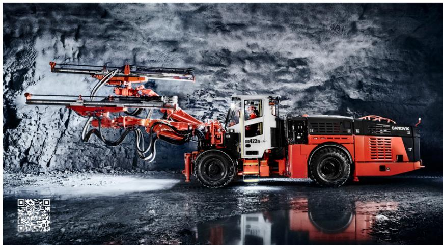
Figura 2.5: Perforadora jumbo eléctrica de Sandvik modelo DD422iE
