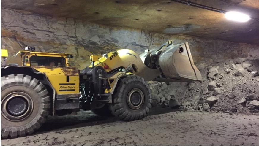
Figura 2.3: Cargador LHD eléctrico de Epiroc modelo ST14 con baterías.
