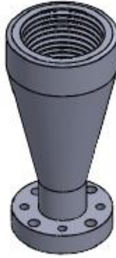
Figura 2.5: Antena tipo bocina corrugada (imagen tomada de reporte interno de Rocio Molina, 2020)
