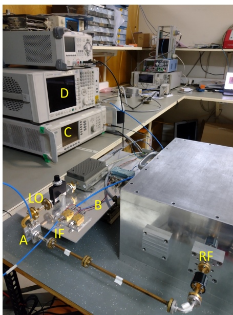
Figura 5.30: Montaje experimental fuera del criostato de prueba. (A) Mezclador con la entrada de la RF, LO y salida de la IF. (B) Placa del sistema de LO. (C) Generador de señal de LO. (D) Analizador de señales para IF.
