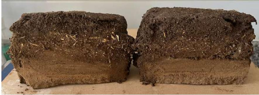
*Figura 23. Muestra resultante luego de ensayo de goteo, cortado a la mitad.*
