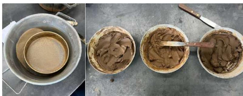
*Figura 6. Proceso de tamizado en malla N°40 (izquierda) y mezclas de tierra hidratadas para su saturación de 24 horas (derecha).*
