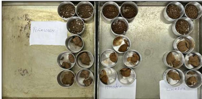
Figura 8. Cápsulas con muestras de tierra de cada ensayo luego de 24 horas en el horno a 60°C.
