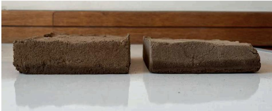
Figura 12. Resultados de ensayo capilar en muestras de tierra de Peñalolén.
