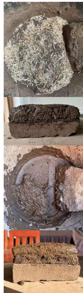
Figura 21. Proceso de elaboración de revoque.
