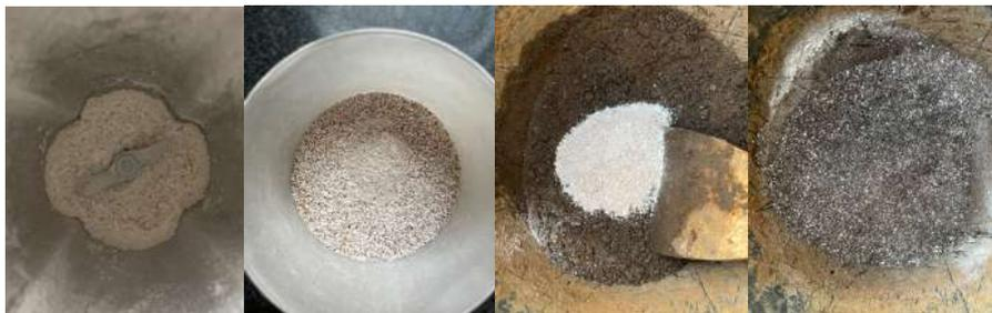
*Figura 16. Proceso mezcla ESP. Se muele ESP en licuadora hasta obtener grano más fino. Se agrega a la mezcla de tierra y se revuelve.*
