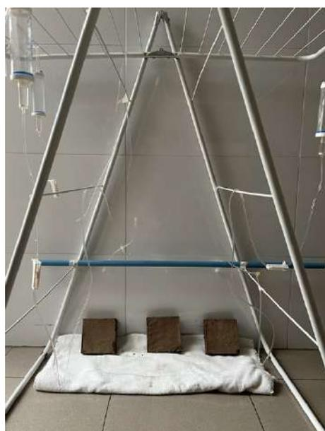
Figura 19. Montaje para ensayo de goteo.
