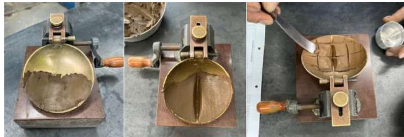
*Figura 7. Proceso manual del ensayo de Límite Plástico en instrumento Casagrande.
