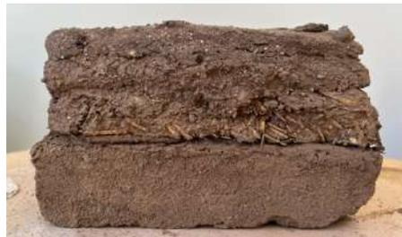
*Figura 22. Muestra con 3 capas de revoque.*
