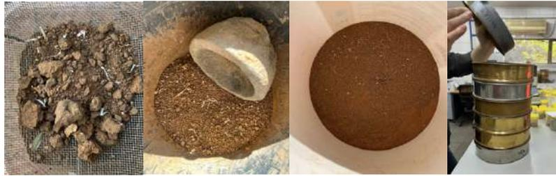
Figura 4. Proceso de afinación de tierra mediante mortero y ensayo de tamizado.
