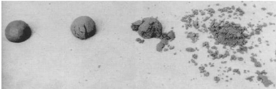
Figura 1. Prueba caída de la bola.
