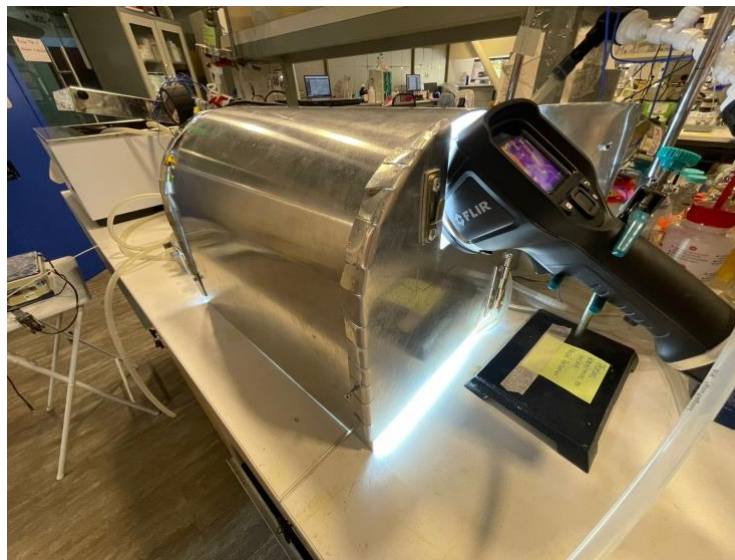
Figura 4.6: Montaje experimental de fotorreactor y cámara termográfica FLIR E6-XT .
