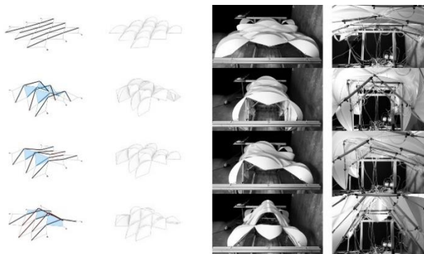
Fig. 9: Diagramas de Kangaroo 2 y prototipo accionado. Fuente: Sistemas Reconfigurables de Tensegridad.
