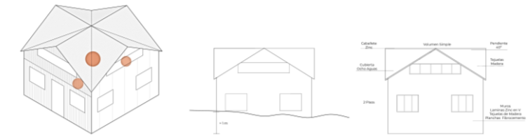
Figuras 20. Catastro de daños observados Vivienda F
