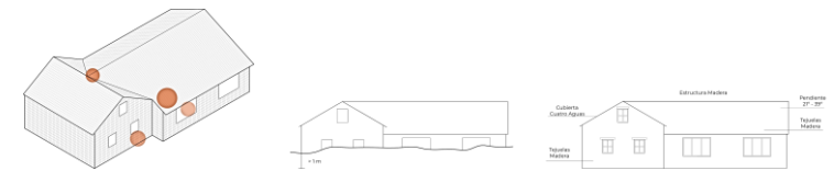
Figuras 26. Catastro de daños observados Vivienda L
