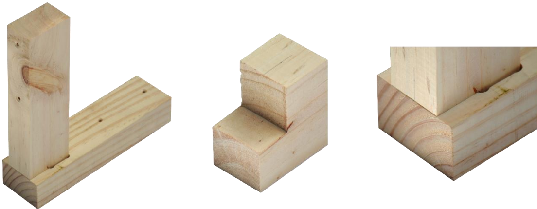
Figura 21: Ensamble caja y espiga unilateral | Detalle espiga 3 | Detalle ensamblaje. Fuente: Elaboración propia.
