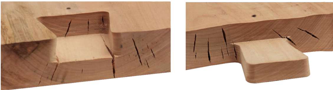
Figura 33: Detalle de las grietas en el coigüe húmedo en proceso de secado. Fuente: Elaboración propia.
