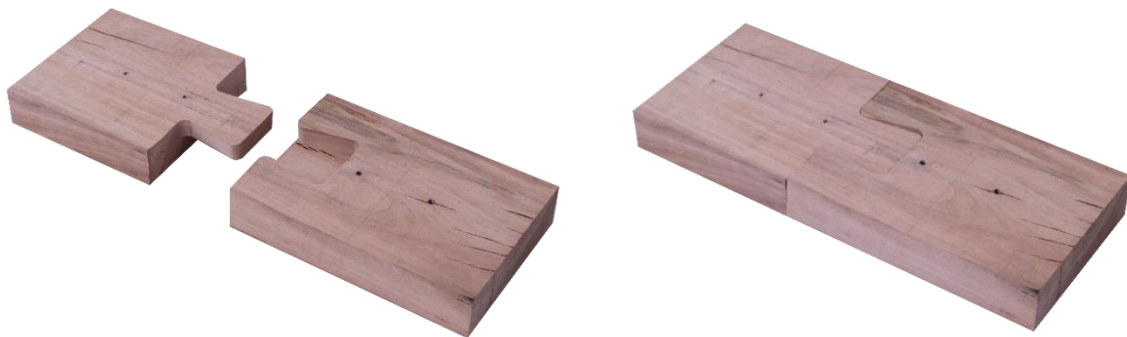
Figura 28: Ensamble media cola de milano prototipo en mañío con tolerancia 0 mm. Fuente: Elaboración propia.
