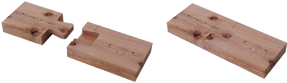
Figura 28: Ensamble media cola de milano prototipo en mañío con tolerancia 0 mm. Fuente: Elaboración propia.
