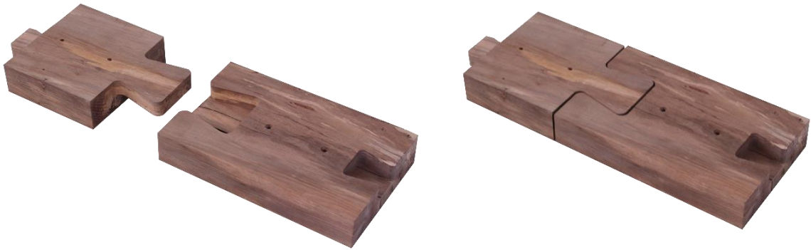
Figura 26: Ensamble media cola de milano prototipo en canelo con tolerancia 0.1 mm. Fuente: Elaboración propia.
