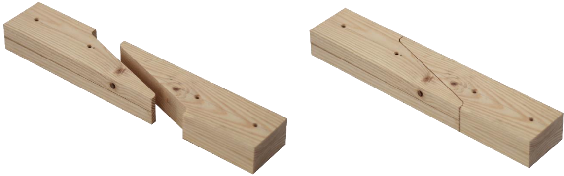
Figura 15: Empalme pico de flauta prototipo tolerancia 0 mm. Fuente: Elaboración propia.
