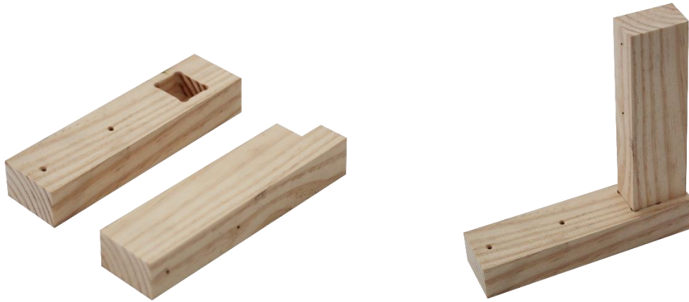
Figura 7: Ensamble caja y espiga unilateral. Fuente: Elaboración propia.
