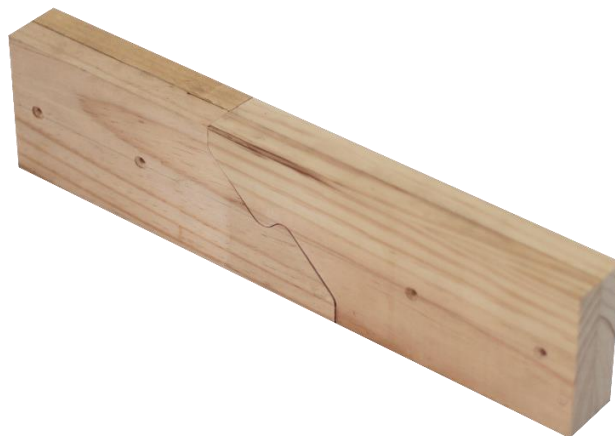
Figura 17: Empalme rayo de júpiter prototipo tolerancia 0.2 mm | Contacto y fricción eficaz. Fuente: Elaboración propia.
