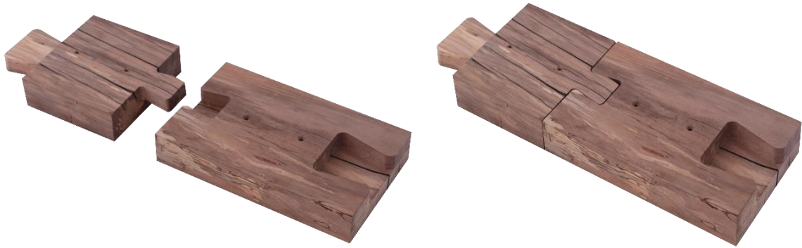
Figura 25: Ensamble media cola de milano prototipo en canelo con tolerancia 0.2 mm. Fuente: Elaboración propia.
