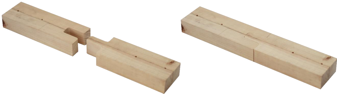
Figura 13: Ensamble quijera prototipo tolerancia 0.2 mm. Fuente: Elaboración propia.
