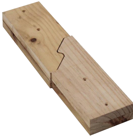
Figura 16: Empalme rayo de júpiter prototipo tolerancia 0 mm | Desfase en las caras y piezas. Fuente: Elaboración propia.
