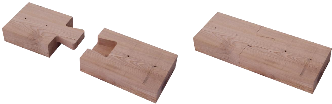
Figura 27: Ensamble media cola de milano prototipo en mañío con tolerancia 0.1 mm. Fuente: Elaboración propia.
