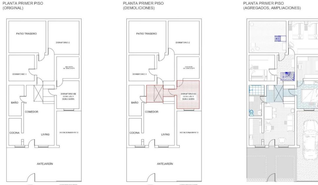
Figura 28: Planimetría con proceso de modificaciones a vivienda de Recoleta<sup>27</sup> (Fuente: Elaboración propia)
