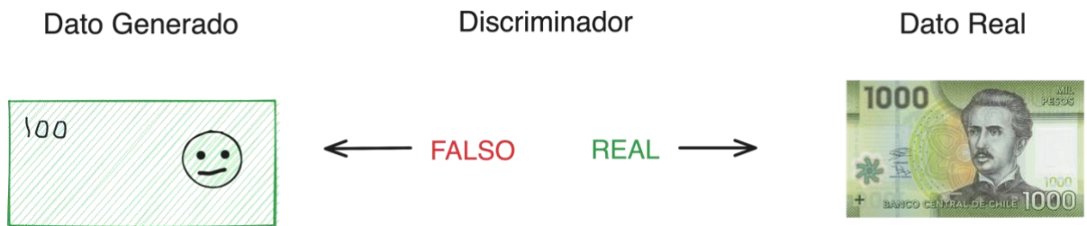
Fig. 8 Proceso de una GAN. Elaboración propia según ejemplos de Google Machine Learning
