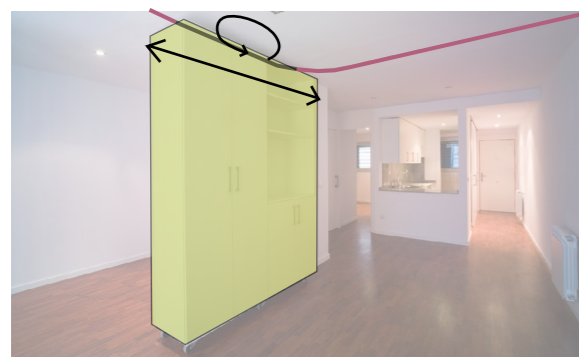
Fig. 21: Mueble multidireccional con riel a lo largo de él. Fuente: Plataforma Arquitectura (2011) 19 Viviendas de Alquiler para jóvenes en el Centro Histórico / Pàmpols Arquitecte.
