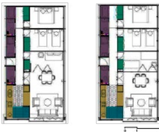
Vivienda tipo C: Panel plegable monodireccional
