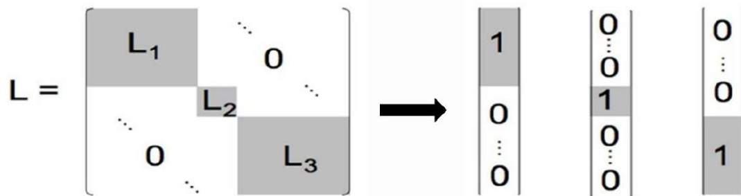
Figura 3-3 Representación esquemática de la matriz de afinidad. A esta matriz se le calculan los vectores propios para la división de los grafos.
