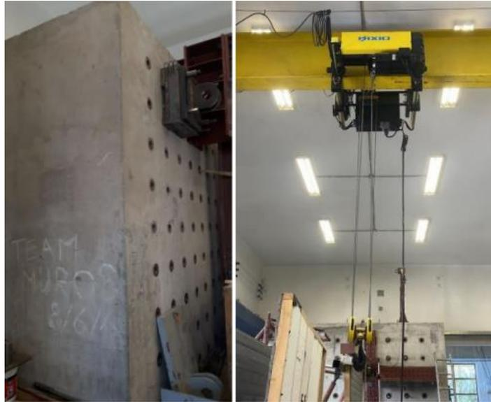
*Figura 4.2 Muro de Reacción y Puente Grúa.*
