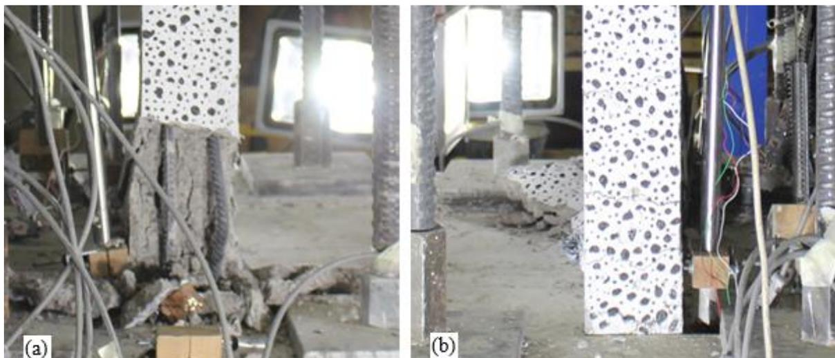
*Figura 5.11 (a) Coronamiento lado Este, pandeo de barras longitudinales - (b) Coronamiento lado Oeste, agrietamiento. Deriva 2,0%.*
