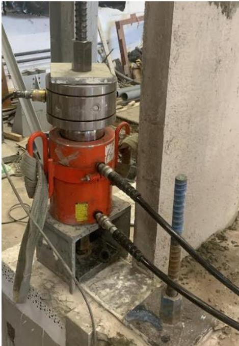
*Figura 4.7 Postensado de barras verticales, Fundación - Losa de Reacción.*
