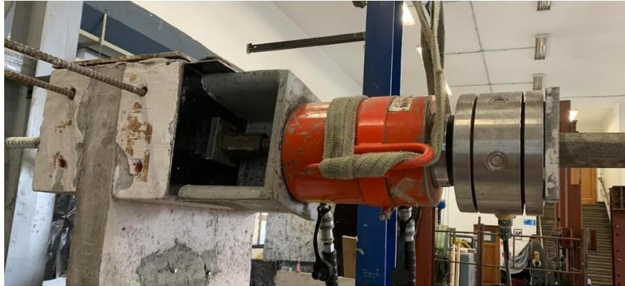
*Figura 4.8 Postensado de barras horizontales, Viga de transferencia – Muro.*
