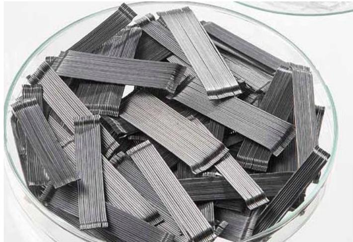
*Figura 1.2 Fibras de acero Dramix 3D 65/35.*
