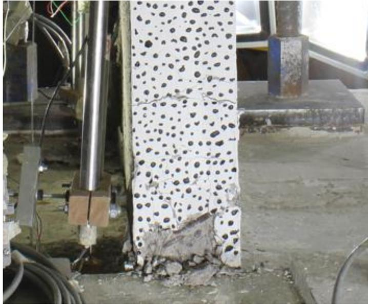
*Figura 5.19 Pérdida recubrimiento lado Este, deriva 3,2%.*
