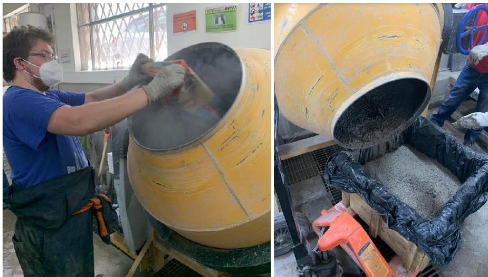
*Figura 3.11 Uso de la betonera para hormigonado.*
