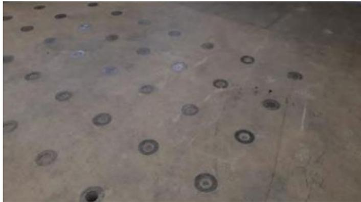
*Figura 4.3 Losa de Reacción.*
