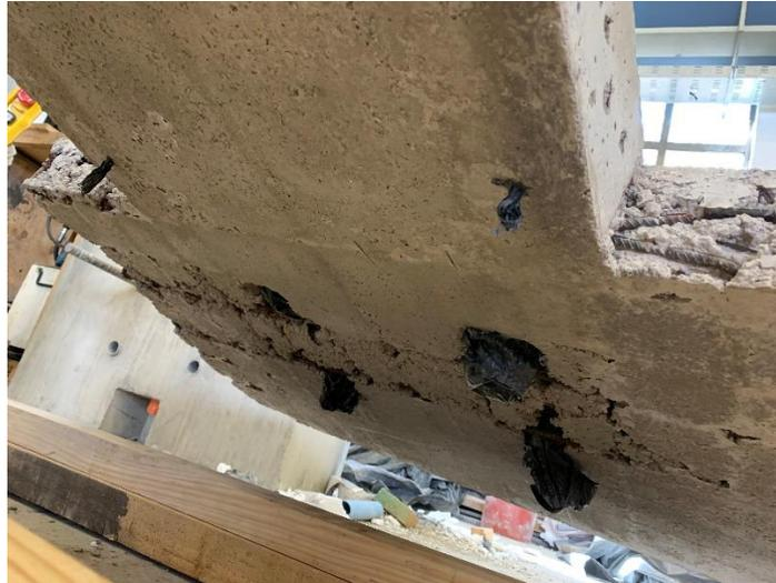
*Figura 3.14 Nidos observados en el Muro sin fibras luego de quitado el moldaje.*
