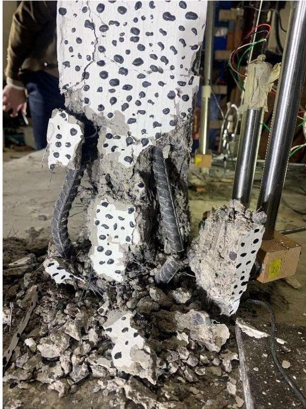
*Figura 5.20 Pandeo y corte de barras longitudinales, deriva 4,0%.*
