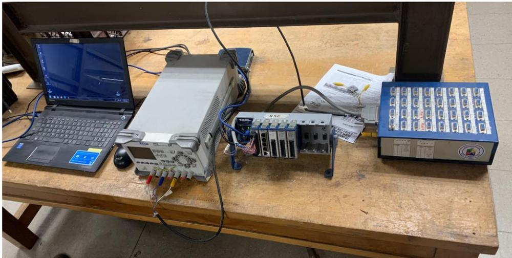
*Figura 4.13 Equipos para conexión de sensores LVDT.*
