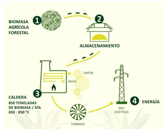
Figura 2.2: Proceso de generación de energía con biomasa agrícola y forestal [5].
