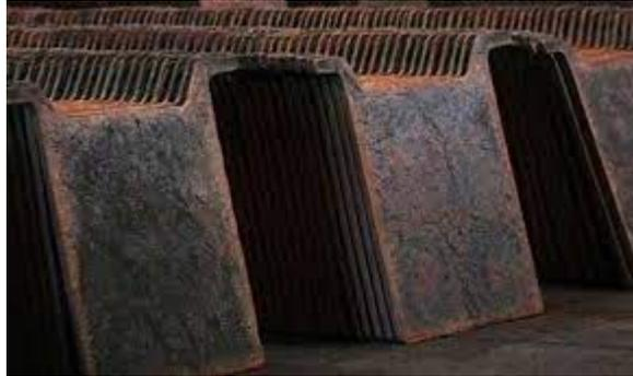
**Figura 4: Ánodos de cobre**
