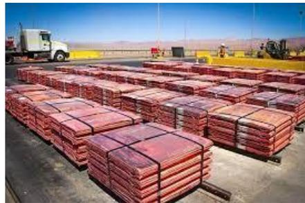
**Figura 2: Cátodos de cobre**
